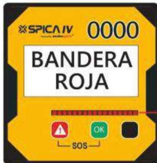
La pantalla muestra el mensaje “BANDERA ROJA” y la hilera de luces LED parpadea en rojo. El altavoz emite un fuerte pitido intermitente
